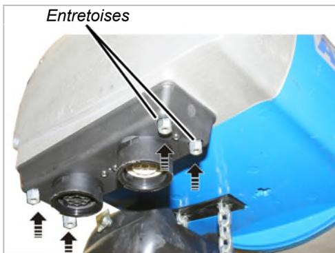
→ Visser les 4 entretoises à la place des vis à tête cylindrique dans le boîtier connecteur. Bien serrer manuellement.
